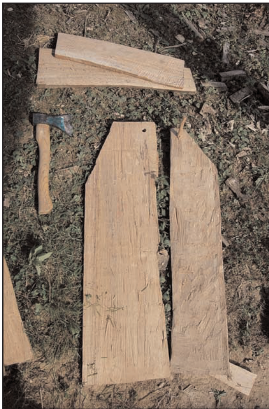
Fig. 15 : bardeaux à about rabattu et cheville décalée
