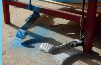
Un clapet en forme de «pince à linge métallique» à actionner au pied par une pédale de scooter. A valve in the form of a "metal clothes peg", to be activated with the foot on a scooter pedal.
