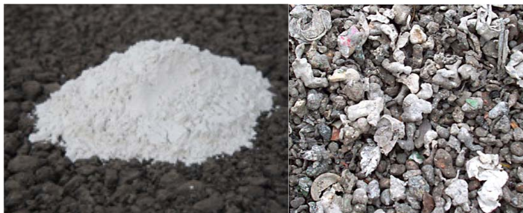
gauche, du laitier moulu Ecocem. A droite, des mâchefers d'incinération de déchets non dangereux 69
