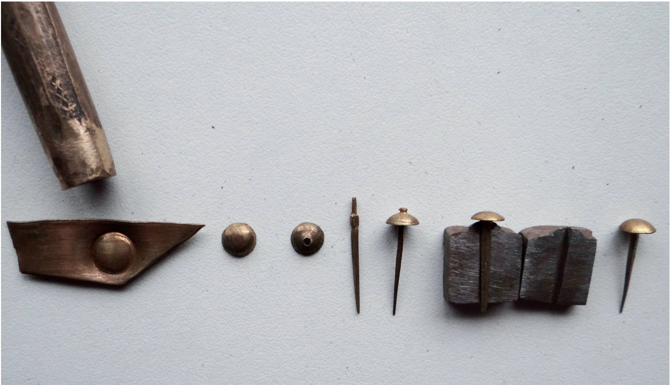
Fig. 12. Les clous. À gauche l'emporte-pièce, puis suivent les différentes étapes de la fabrication d'un clou (cl. J. Dubos).
