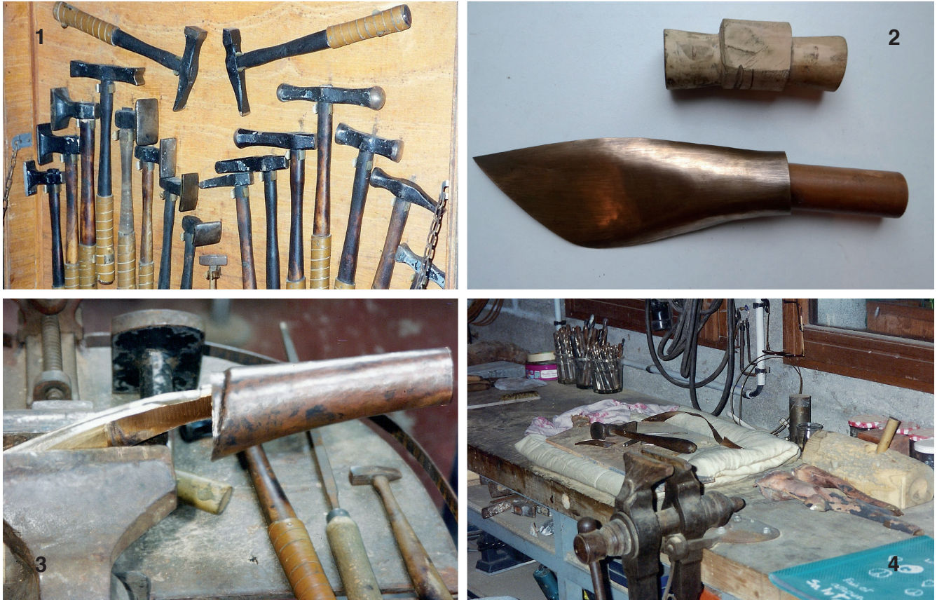
Fig. 2. Les outils utilisés pour l'expérimentation. Certains ont été spécifiquement fabriqués. 1. Les marteaux ; 2. Tas en bois ; 3. Exécution d'une patte avant sur un bois rond ; 4. L'établi avec l'étau et un martyr posé sur coussin (cl. J. Dubos).
