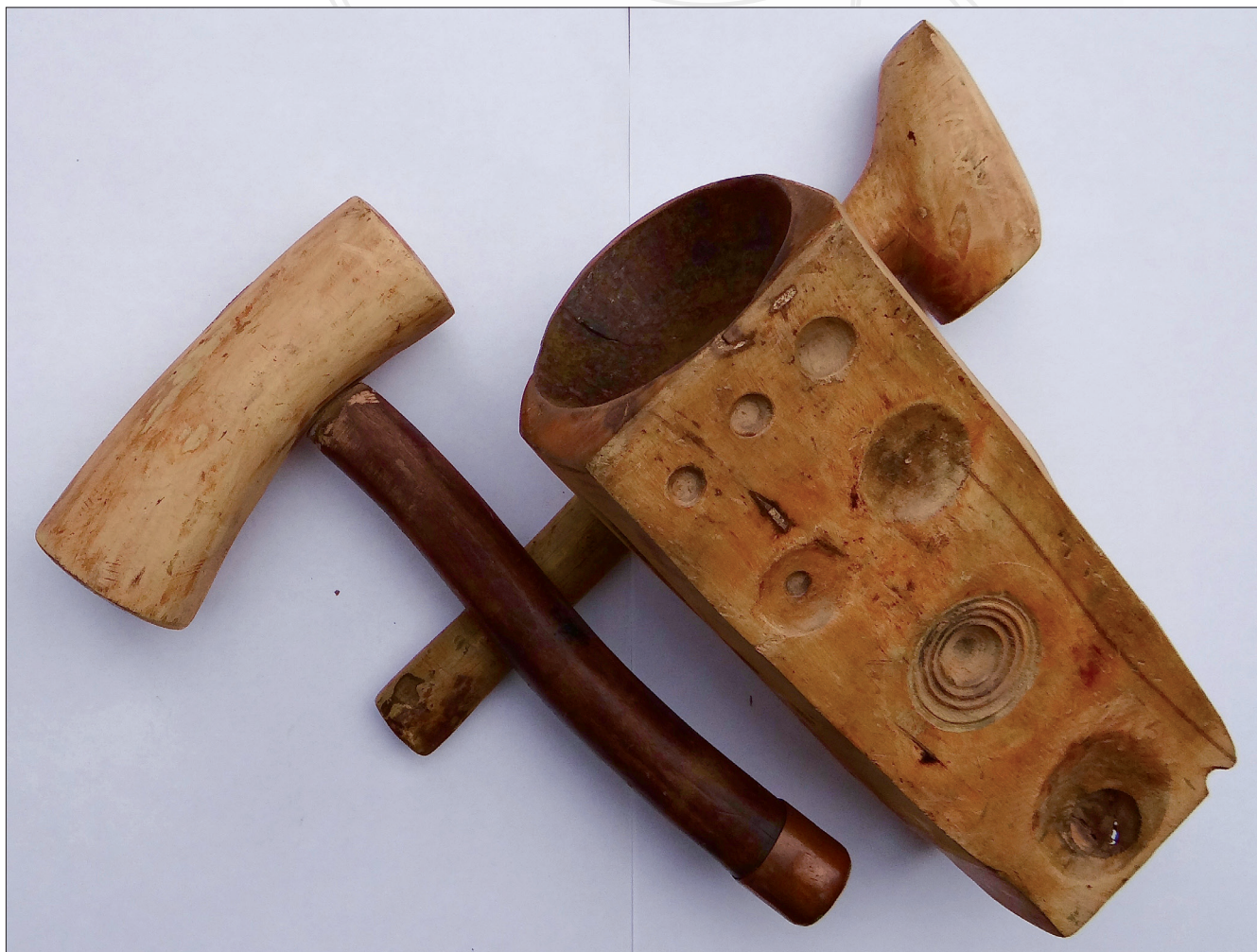
Fig. 11. Maillets et dé à emboutir en buis dans lequel ont été creusées les salières utilisées lors de la fabrication du sanglier (cl. J. Dubos).
