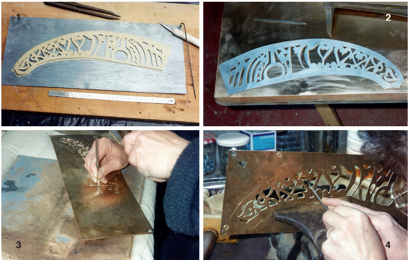
Fig. 10. Fabrication de la crinière. 1. Le modèle en plastiline ; 2. Gabarit en zinc du modèle en plastiline ; 3. Découpe des motifs au burin sur plaque en bronze ; 4. Finition des découpes à la lime (cl. J. Dubos).
