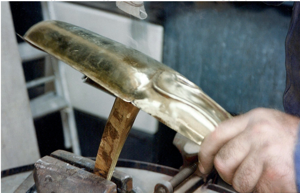
Fig. 6. Planage de finition du métal, sans recuit, effectué avec un martyr en cuir fixé sur la panne du marteau pour éviter les marques de carres (cl. M. Dubos).
