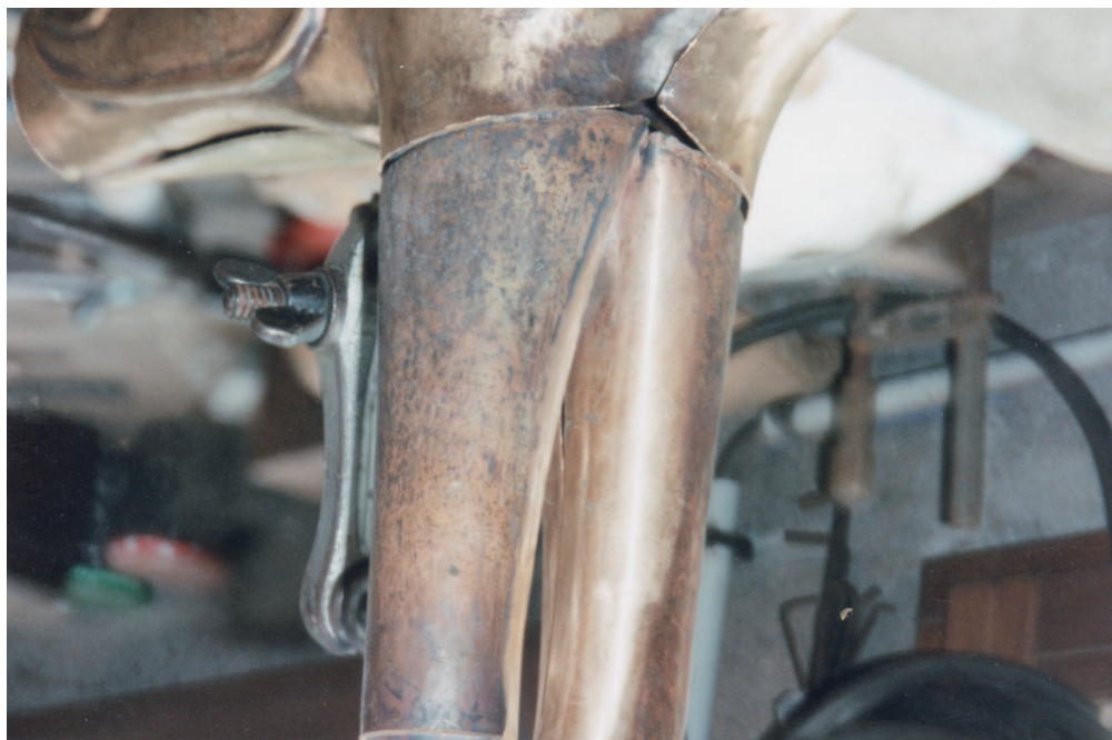
Fig. 8. Assemblage abrevé avec recuit, réalisé en partie haute pour permettre l'emboîture sur le corps (cl. J. Dubos).
