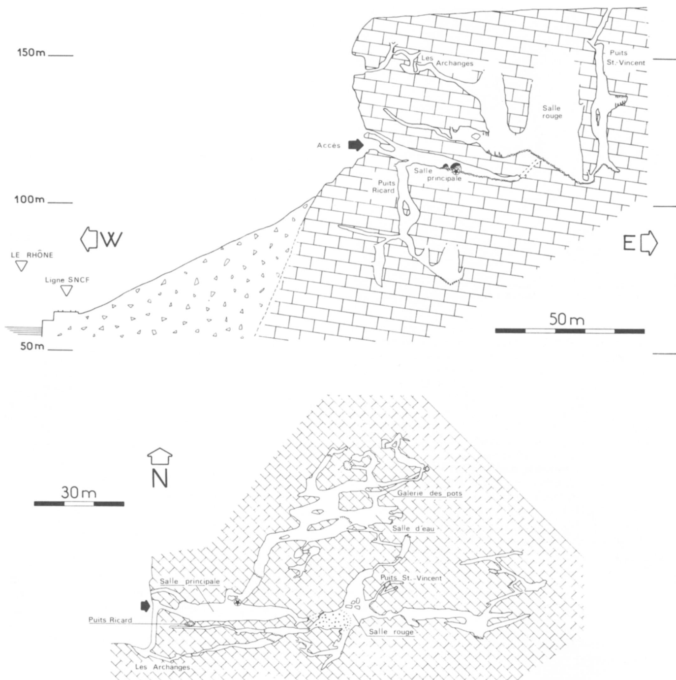
Fig. 2 - Coupe du massif calcaire urgonien constituant la rive gauche, au niveau du réseau de la Baume des Anges, dont le plan montre l'extension générale. L'étoile indique l'emplacement de la zone étudiée.
