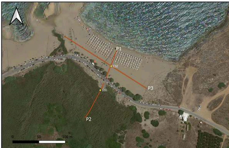
Fig. 1. Carte de localisation des transects ERT et des sondages réalisés lors des prospections géomorphologiques et géophysiques sur la plage et le cordon dunaire.
