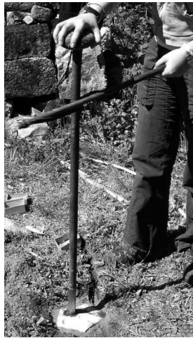
Figure 7. Forage tubulaire expérimental d'un bloc de marbre avec un foret à archet, un tube en cuivre, des abrasifs et de l'eau.
