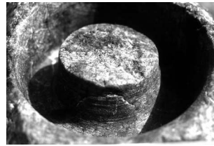
Figure 8. Exemple de carotte de forage expérimental se formant au centre du forage tubulaire.
