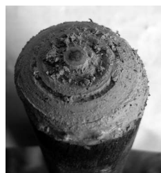
Figure 12. Extrémité d'une mèche de foret pleine expérimentale en bois.
