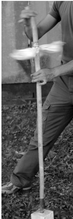
Figure 6. Forage tubulaire expérimental d'un bloc de marbre avec un foret à poids égyptien, un tube en cuivre, des abrasifs et de l'eau.
