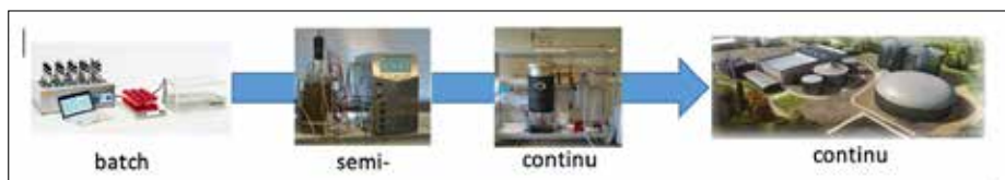
Figure 7. Scaling up de la méthanisation de macroalgues. Échelle des procédés mis en œuvre par l'IRD et ses partenaires (de gauche à droite : 15 fois 500 mL ; 2 L ; 40 L ; plusieurs milliers de m 3 )
