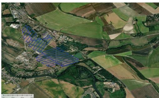
28 Garennnes sur Eure, « Bellevue », levé LiDAR : trajectoire des vols [© aird'éco drone]
