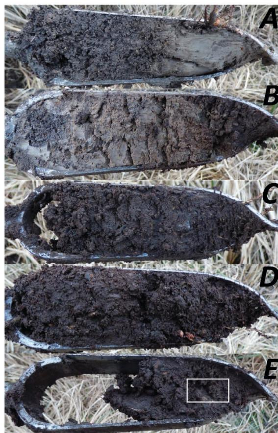
94 Unités sédimentaires prélevées par sondage à la tarière pédologique de la séquence de remblaiement en rive droite dans sa portion aval au lieu dit « le Pont au Roy ». A. entre 0 et 20 cm ; B. entre 20 et 40 cm ; C. entre 40 et 60 cm ; D. entre 60 et 80 cm ; E. entre 80 et 90 cm. Le rectangle blanc localise le prélèvement de restes ligneux pour une datation radiocarbone au laboratoire Beta Analytic (Beta 593642 : 1353 1517 cal BP ; 433 598 cal AD) [© T. Piau 2021]
