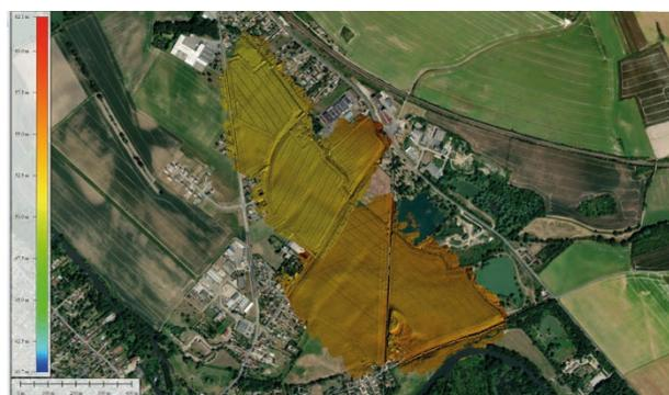
31 Garennnes sur Eure, « Bellevue », levé LiDAR : MNT sur fond Bing Aerial, Fz=1 [© aird'éco drone]
