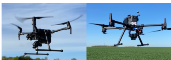
Caméra FLIR DUO (mesure IR et RGB simultanée) sous un Matrice 210 et 300
