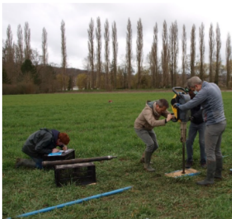
78 Carottage réalisé à l'aide d'un carottier à percussion cobra MK1 et extraction de la gouge sur la commune de Saussay au lieu dit « Les Terres Noires » [© F. Dugast 2021]
