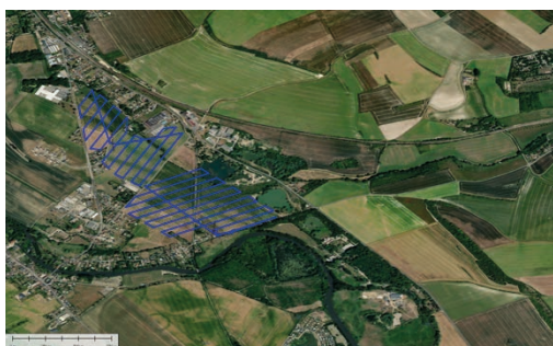
28 Garennes sur Eure, « Bellevue », levé LiDAR : trajectoire des vols [© aird'éco drone]
