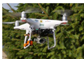
Caméra FLIR simple sous un Phantom 4 V2
