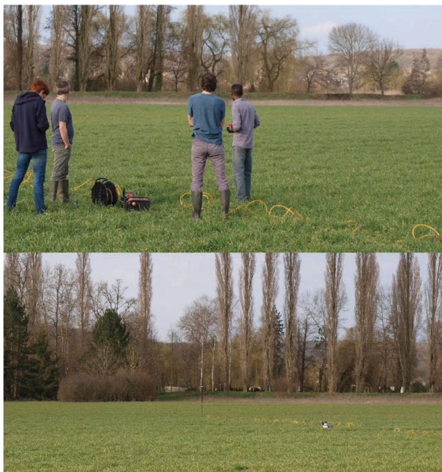
75 Profil 2 de tomographie de résistivité électrique réalisé en collaboration avec C. Virmoux (UMR 8591) au lieu dit « Les Terres Noires » sur la commune de Saussay à l'aide d'un système multi électrodes Abem Terrameter LS et d'un DGPS [© F. Dugast 2021]
