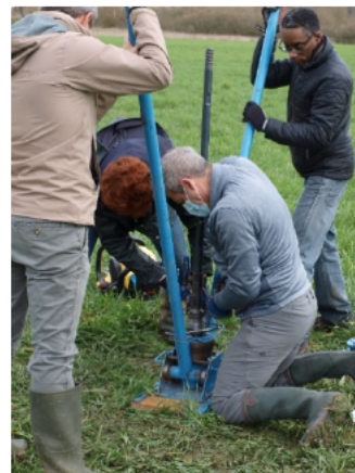
78 Carottage réalisé à l'aide d'un carottier à percussion cobra MK1 et extraction de la gouge sur la commune de Saussay au lieu dit « Les Terres Noires » [© F. Dugast 2021]
