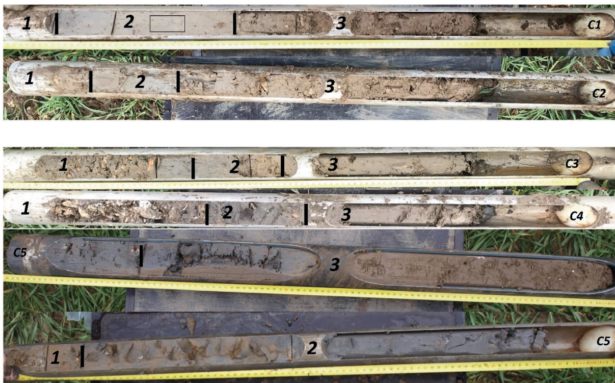
79 Séquences sédimentaires des remblaiements de chenaux de l'Eure sur la commune de Saussay au lieu dit « Les Terres Noires » prélevées par carottage. Série sédimentaire 1 : grave à silex roulés, parfois sableuse, dans une matrice argileuse. Série sédimentaire 2 : limons argilo sableux. Le rectangle noir localise l'échantillon prélevé pour datation radiocarbone qui a livré une date de 4220 \pm 30 BP [Beta 593639 ; 4626 4854 cal BP ; 2678 2905 cal BC]. Série sédimentaire 3 : limons sableux et/ou sables limoneux [© T. Piau 2021]
