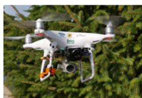
Caméra FLIR simple sous un Phantom 4 V2
