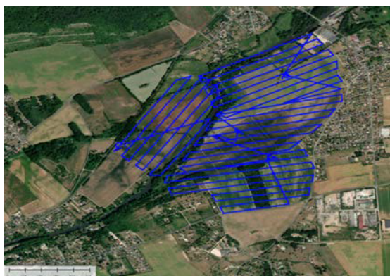
42 Plaines de Saussay « Les Terre noires » et Croth « La grande Épine », levé LiDAR : trajectoires de vol [© aird'éco drone]
