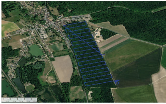
23 Breuilpont, levé LiDAR : trajectoires de vol [© aird'éco drone]
