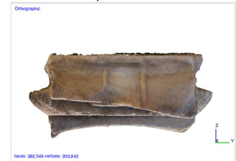
Vérification de la rotation sur une vue latérale (gauche ou droite) sur le plan YoZ, puis ajustement de la rotation.
