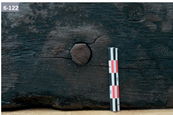
Fig. 6-123 Détail d'un clou en cuivre sectionné lors de la dépose de la membrure (Cl. D. Dubesset).
