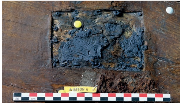
Fig. 6-96 Vue de la plaquette Pb6 positionnée sous le demi-couple M109N. Le bois du bordage V3bN a été entaillé et creusé pour accommoder la plaquette qui couvre un nœud (Cl. Ph. Groscaux).
