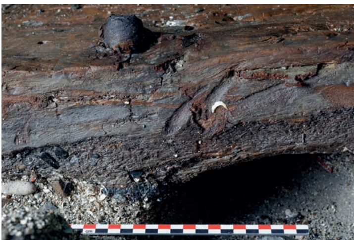
Fig. 6-117 La broche au niveau de la varangue M92 (non conservée). On note que cet assemblage est brisé supérieurement et que sur la face inférieure de la quille s'est formée une concrétion correspondant à sa tête (Cl. Ph. Groscaux).
