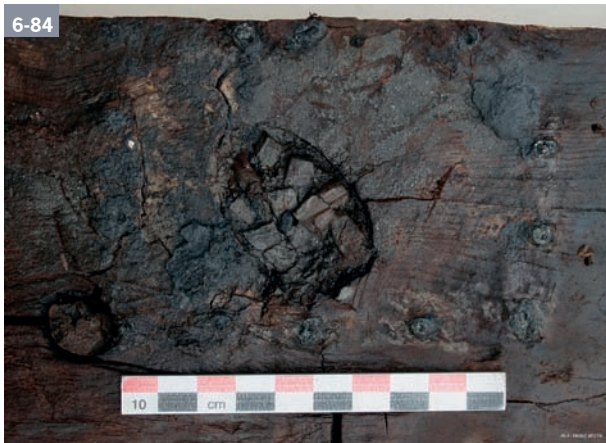
Fig. 6-84 Détail d'une concentration de pinoches placées au niveau d'un nœud du bordage V8bN avant leur recouvrement par une petite plaquette de plomb dont on note des traces sur le bois et les petits clous pour sa fixation (Cl. D. Dubesset).
