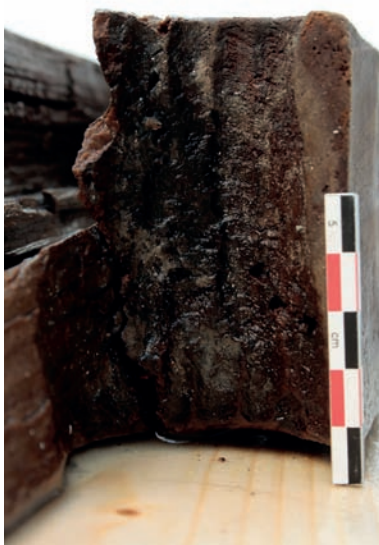
Fig. 6-139 Traces du ciseau utilisé pour façonner le trou d'anguiller d'une membrure (Cl. D. Dubesset).
