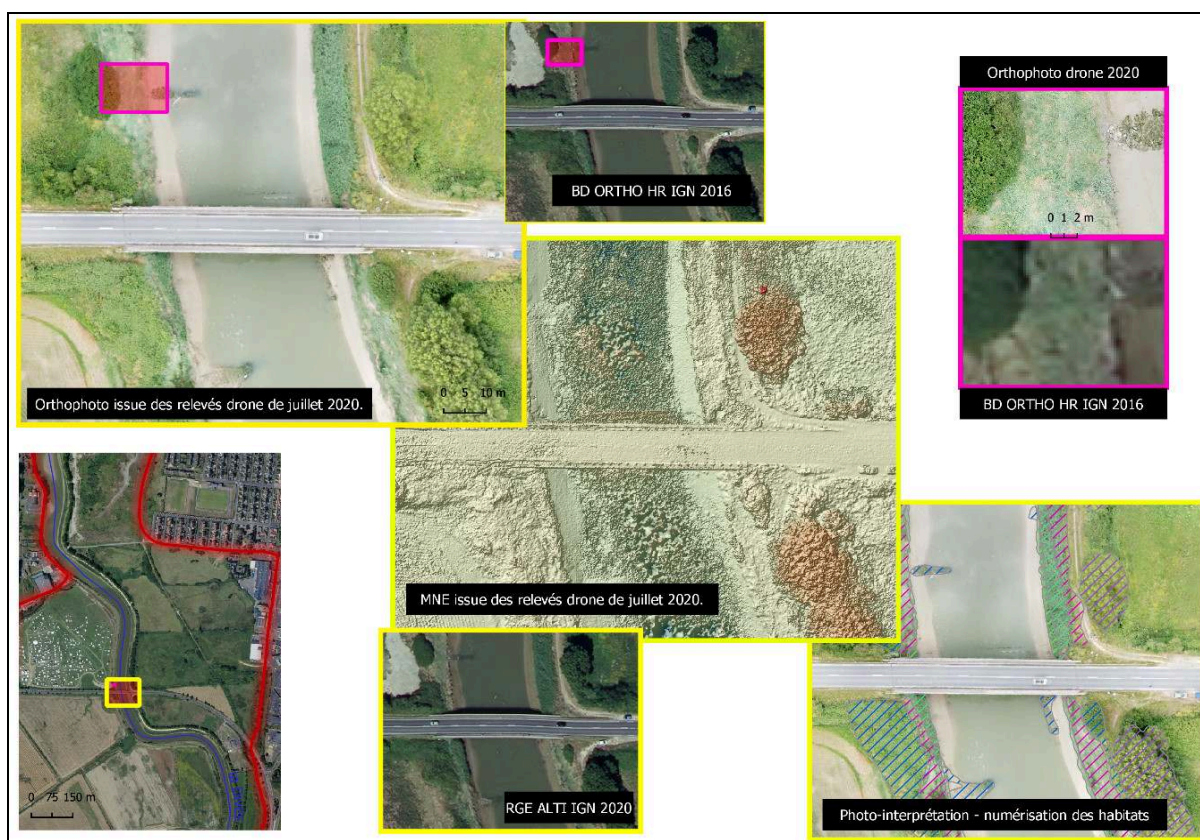
Figure 4 - Résultats du traitement des images drone (orthophoto, modèle numérique d'élévation et numérisation des habitats) et comparaison avec les produits de l'IGN.
