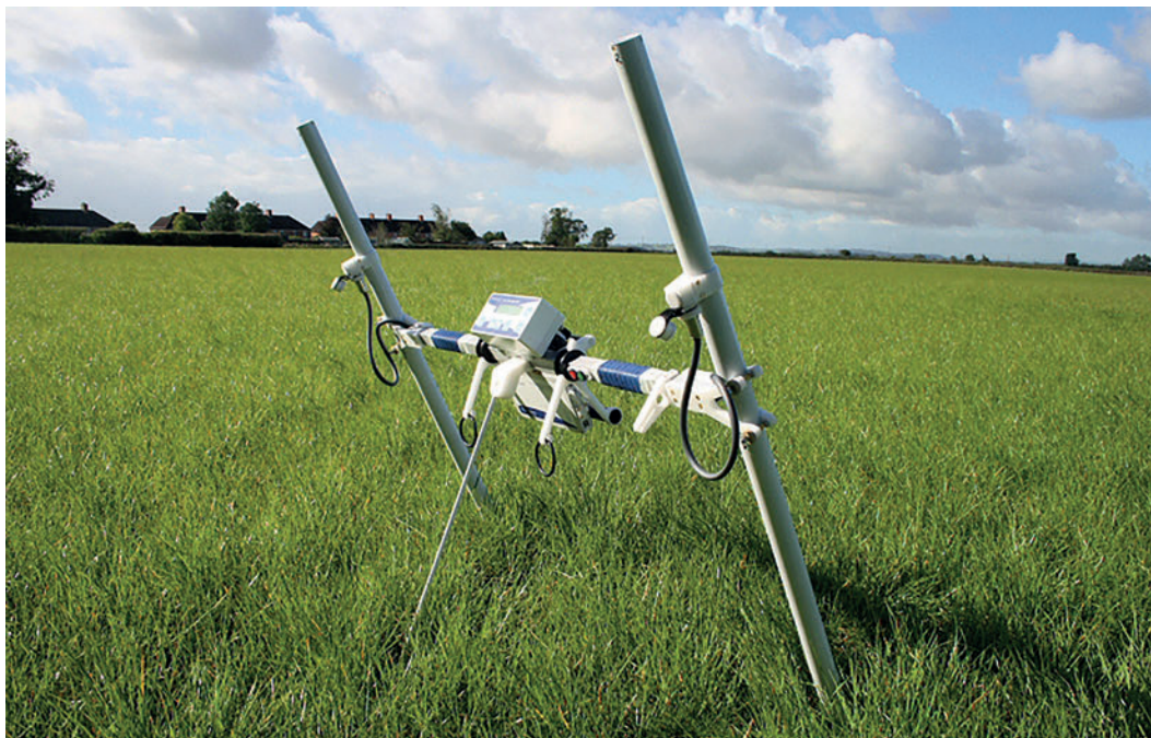
4. Bibracte, Mont-Beuvray. Prospection géophysique sur le versant ouest du Theurot de la Roche. Magnétomètre Bartington Grad-601 (cliché Chr. Sanchez).
