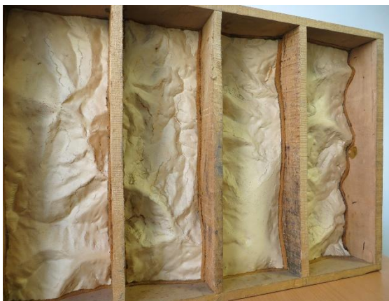
F1922_05/a. Les cartes en relief permettent de bien saisir le modelé du terrain Au cours des années trente et jusqu'en 1955, les plans reliefs sont réalisés avec des planches imprimées sur un carton spécial, déformable après humidification. Ces planches sont mises en forme sur des matrices en plâtre. – Carte en relief au 1:50 000, feuille Guillestre , s.d. [ca. 1950] [photo de l'auteur].
