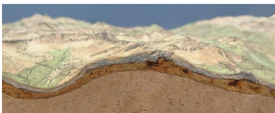
F1922_05/b. Un procédé de fabrication long et délicat Pour assurer la rigidité des planches, elles sont montées sur des tampons de feutre puis sur des structures en bois chantourné qui suivent les grandes lignes du relief. – Carte en relief au 1:50 000, feuille Guillestre , s.d. [ca. 1950] [photos de l'auteur].
