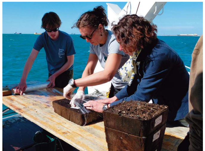
Prélèvement de sections de pieux en bois à bord du navire André Malraux pour leur étude ultérieure en 2016 / Prelievo di sezioni di pali in legno a bordo della nave André Malraux per ulteriori studi nel 2016 (F. Marty / Métropole AMP).
