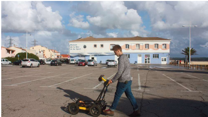
Géoradar sur le parking de la Maison de la Mer / Georadar sul parcheggio della Maison de la Mer a Fos-sur-Mer (Ipsos Facto / University of Southampton).
