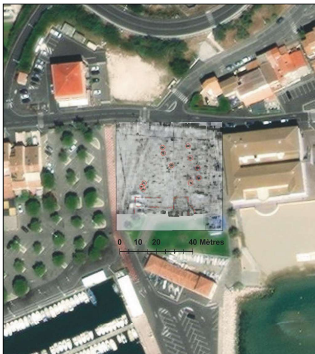
Résultats de la prospection au géoradar sur le parking de la Maison de la Mer. Profondeur : 0.4-0.8 m. Fréquence utilisée : 500 Mhz / Risultati della prospezione con georadar sul parcheggio della Maison de la Mer. Profondità 0.4-0.8 m. Frequenza : 500 Mhz (Ipso Facto / Geopat / University of Southampton).
