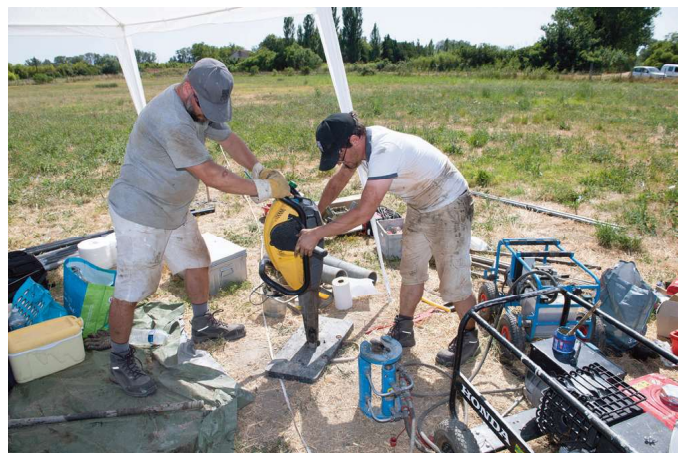
Réalisation d'un carottage en 2020 dans les marais du Vigueirat / Realizzazione di un carotaggio nel 2020 nelle paludi del Vigueirat (L. Roux / AMU - CCJ - CNRS).
