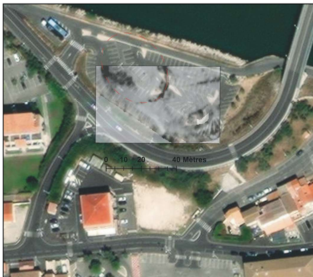
Résultats de la prospection au géoradar sur le parking de la Maison de la Mer. Profondeur : 0.4-0.8 m. Fréquence utilisée : 500 Mhz / Risultati della prospezione con georadar sul parcheggio della Maison de la Mer. Profondità 0.4-0.8 m. Frequenza : 500 Mhz (Ipso Facto / Geopat / University of Southampton).
