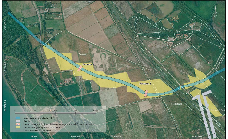
Prospections géophysiques et carottages sur le paléo-chenal des marais du Viguirat / Prospezioni geofisiche e carotaggi sul paleocanale delle paludi del Viguirat (V. Dumas / AMU - CCJ - CNRS).
