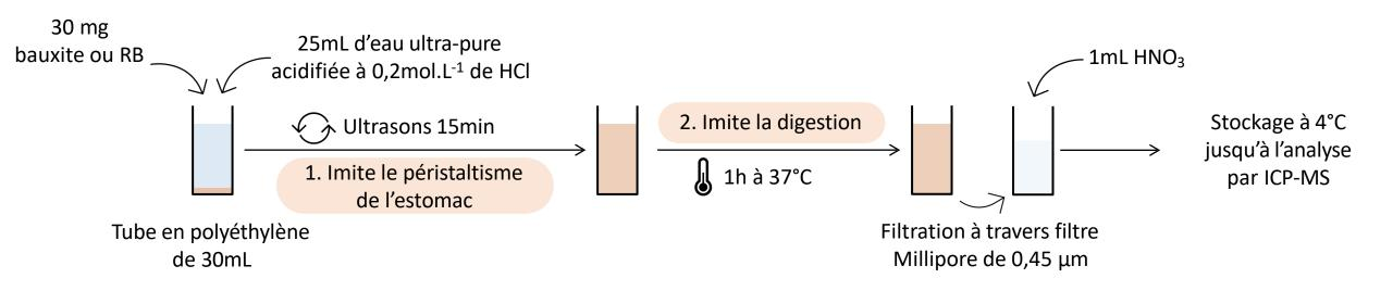
Extraction sur 2 fractions (< 50 µm et 50-100 µm) de bauxite et de résidus de bauxite avec 5 réplicats par de l'acide chlorhydrique diluée à 0,65%
