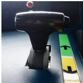
Manipulateur rotatif en T avec contacteur sensible de veille à l'extrémité droite du T. La hauteur de la poignée est de 11 cm.
