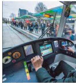
Manipulateur rotatif en T asymétrique avec contacteur de veille sur l'extrémité droite du manipulateur. L'asymétrie du T vise à compenser l'éloignement axial pour restreindre l'abduction de l'épaule. L'avant-bras est alors tout le temps suspendu. Pour éviter cela, les conducteurs saisissent le manipulateur sur le côté et veillent au pied.
