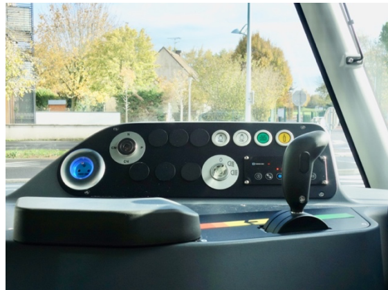
Manipulateur rotatif (brevet 2011) sur le tramway de Caen. Par rapport à celui de 2009, le contacteur de veille occupe une surface beaucoup plus importante permettant une saisie « naturelle » pour toutes les morphologies.
