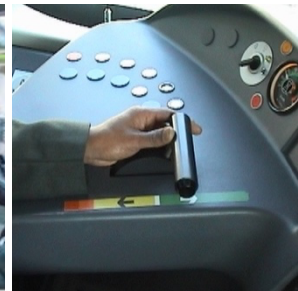
Manipulateur rotatif en T asymétrique avec contacteur de veille sur l'extrémité droite du manipulateur. L'asymétrie du T vise à compenser l'éloignement axial pour restreindre l'abduction de l'épaule. L'avant-bras est alors tout le temps suspendu. Pour éviter cela, les conducteurs saisissent le manipulateur sur le côté et veillent au pied.
