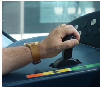
Saisie du manipulateur conforme à son affordance c'est-à-dire en pronation avec le pouce sur le contacteur de veille et l'avant-bras suspendu
