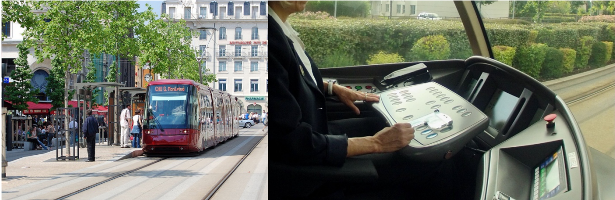
Translohr, place de Jaude. Clermont-Ferrand. Ce tramway est guidé par un rail central. (source : wikipedia. Fabien 1309).
