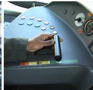
Manipulateur rotatif en T asymétrique avec contacteur de veille sur l'extrémité droite du manipulateur. L'asymétrie du T vise à compenser l'éloignement axial pour restreindre l'abduction de l'épaule. L'avant-bras est alors tout le temps suspendu. Pour éviter cela, les conducteurs saisissent le manipulateur sur le côté et veillent au pied.
