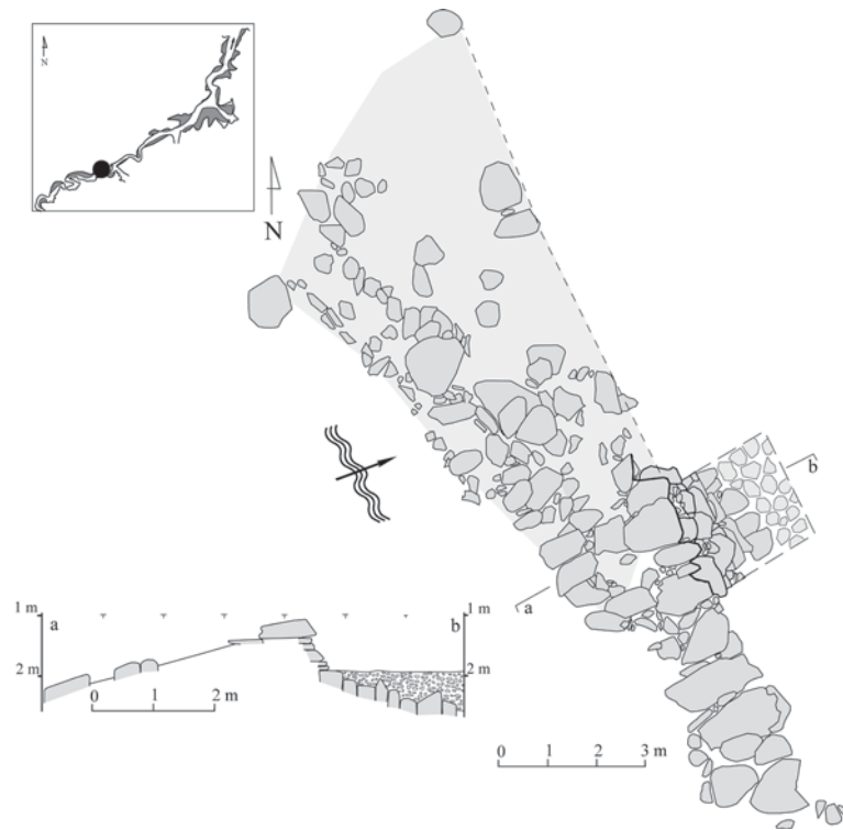
Figure 13. Plan et coupe du barrage inférieur d'al-Ḥuwaydar (relevé et DAO J.-Cl. Roux).
