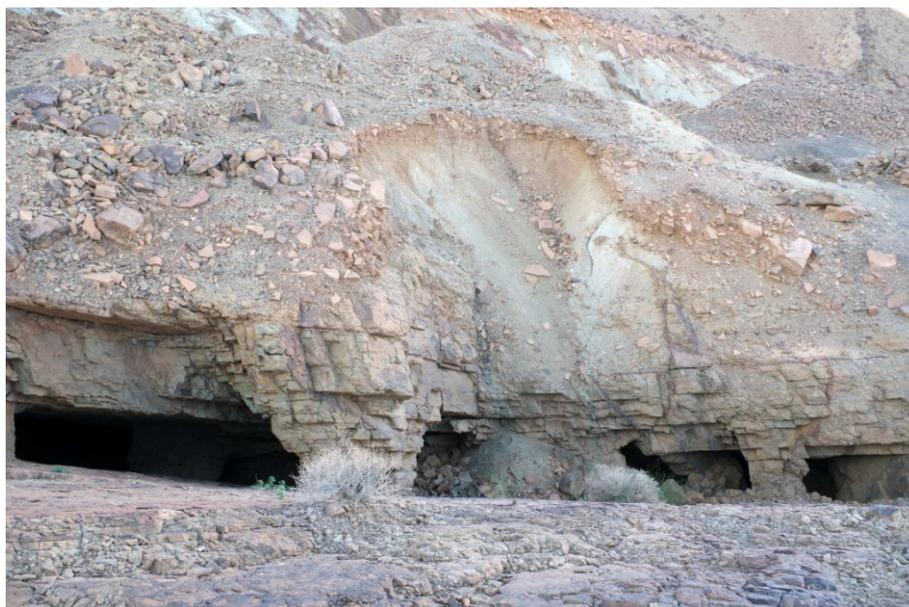
**Fig. 5** : vue en direction du Sud, de l'exploitation ancienne de Tagoudent en contrebas d'une falaise de 17 m. Le site d'extraction suit la faille abritant la minéralisation de galène argentifère. L'entrée des puits d'accès témoigne d'un travail d'élargissement au pic (période islamique ?) des orifices originellement ovoïdes (période préhistorique ?).
