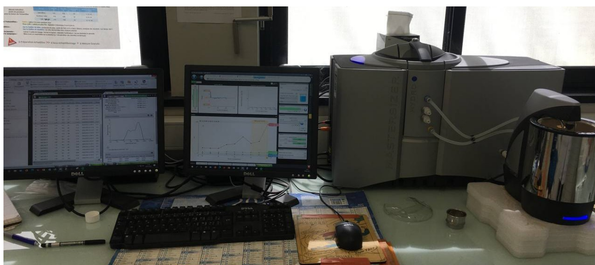
Figure 11 : Granulomètre laser Malvern Mastersizer 3000 (Source : M. GOMA KANY)
