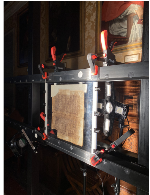
FIGURE 2 Support de parchemin avec vitre en quartz
