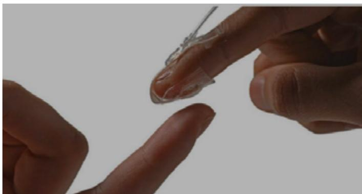
Prototype composé de silicone extensible, de capteurs, d’électrodes et d’« actionneurs pneumatiques souples » (SPA).
