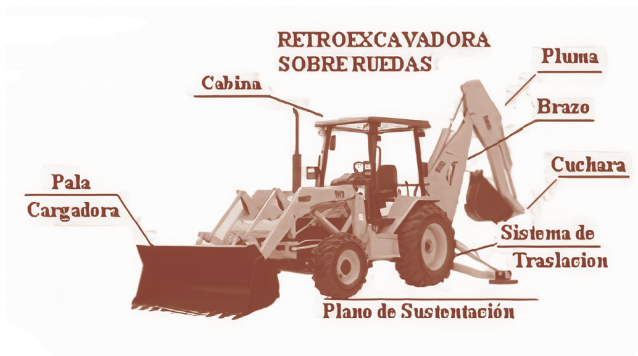
Figura 2. Esquema de las partes de una retroexcavadora
