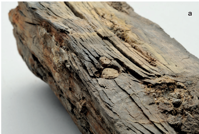
Fig. 16a et b. Toulon 1. Couple de chevilles d'un tenon d'assemblage entre quille et galbord. La cheville plus grande traverse le tenon, la plus petite a, probablement, une fonction de pré-blocage (cl. L. Damelet, CCJ/CNRS).
