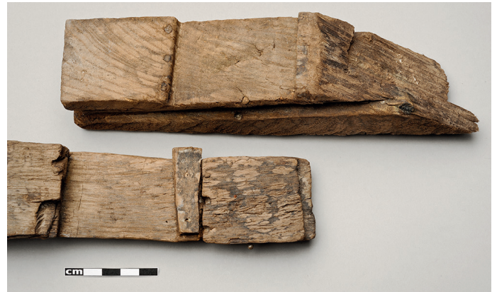
Fig. 45. Toulon 2. L'enture entre la quille (en bas) et le brion d'étambot (en haut). On note la clef de blocage et les rangées de chevilles renforçant les angles internes (cl. L. Damelet, CCJ/CNRS).
