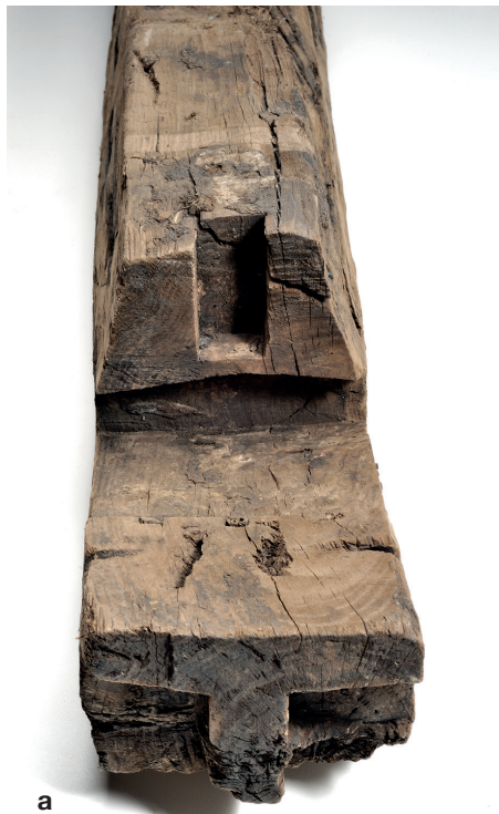
Fig. 120a-c. Toulon 7. L'enture en trait de Jupiter de la quille (cl. L. Damelet, CCJ/CNRS).
