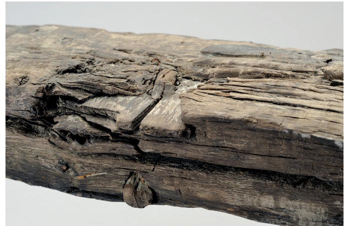
Fig. 15. Toulon 1. Cheville oblique chassée de l'extérieur de la joue de la quille et bloquant un des tenons d'assemblage entre quille et galbord (cl. L. Damelet, CCJ/CNRS).
