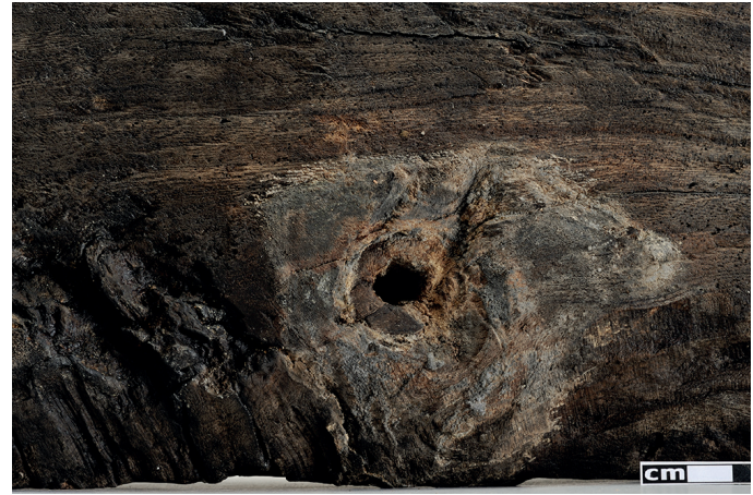
Fig. 25. Toulon 1. Vue de détail du trou laissé par le clou unissant la marotte à la quille. L'empreinte de la tête du clou et les traces d'oxydation sont évidentes (cl. L. Damelet, CCJ/CNRS).
