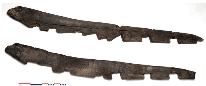
Fig. 32. Toulon 1. Les courbes de contrebutement de la marotte: en haut, la courbe bâbord CB; en bas, la courbe tribord CT (cl. L. Damelet, CCJ/CNRS).
