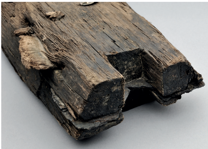
Fig. 104. Toulon 6. L'extrémité de la quille de Toulon 6 au niveau de l'enture en trait de Jupiter. On note que la feuille de plomb est insérée dans une entaille (cl. L. Damelet, CCJ/CNRS).
