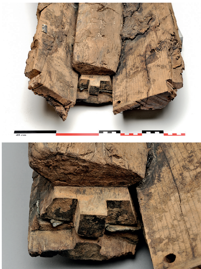
Fig. 107. Toulon 6. Le brion d'étrave au niveau de l'enture avec la quille (cl. L. Damelet, CCJ/CNRS).
