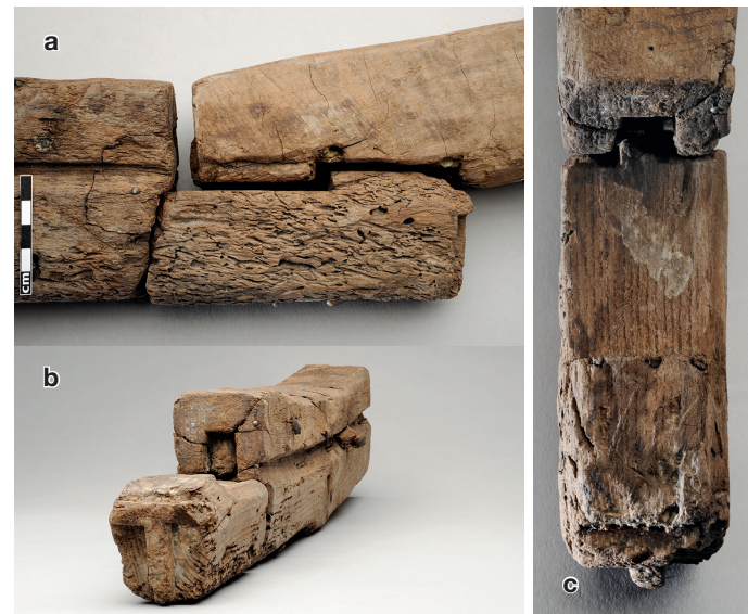
Fig. 46. Toulon 2. L'enture entre le brion (à gauche) et l'étambot (à droite): a) face bâbord; b) vue après démontage de l'étambot; c) détail avec les trois petites chevilles de renforcement du redan interne (cl. L. Damelet, CCJ/CNRS).
