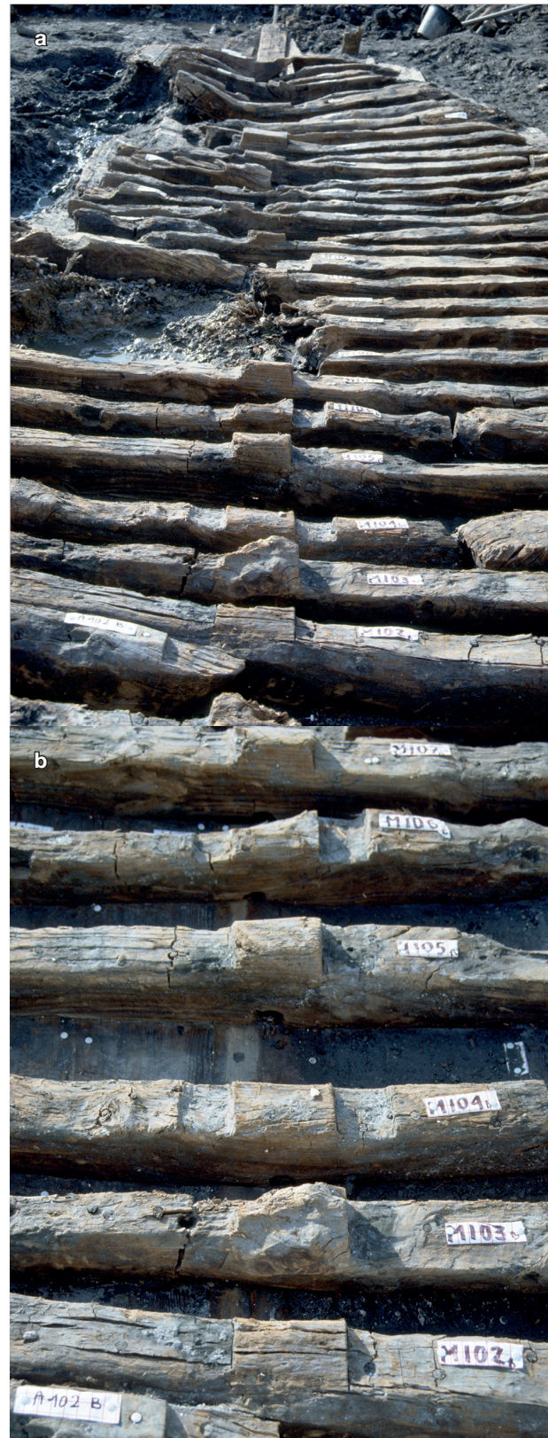
Fig. 97. Toulon 3-4 . Les membrures au niveau de la quille: a) vue depuis le nord-ouest; b) détail des entailles pour l'encastrement de deux carlingots latéraux (cl. CAV).
