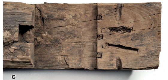
Fig. 120a-c. Toulon 7. L'enture en trait de Jupiter de la quille (cl. L. Damelet, CCJ/CNRS).
