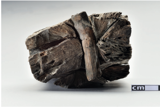
Fig. 9. Toulon 1. Vue en section de la quille et de la semelle. Les deux éléments sont assemblés avec une gournable (cl. L. Damelet, CCJ/CNRS).
