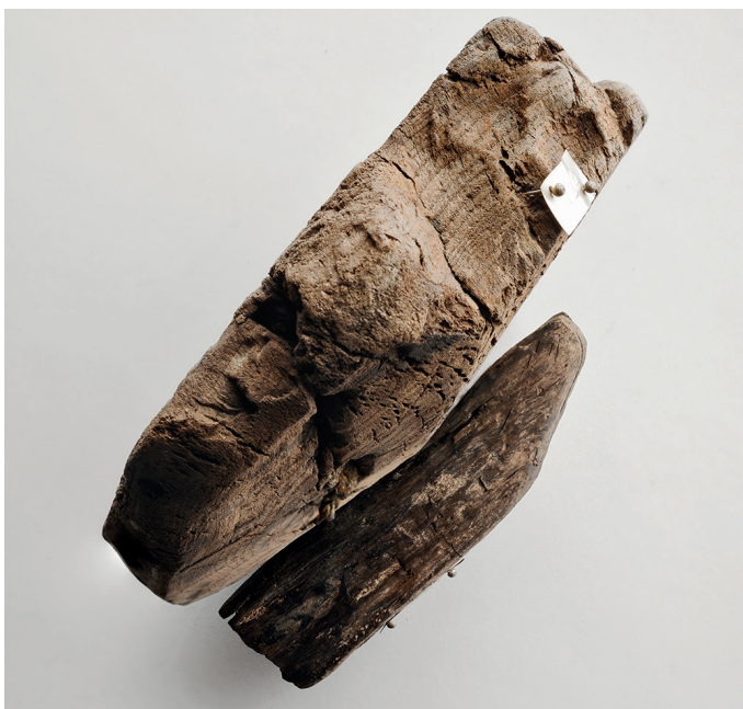
Fig. 61. Toulon 2 . Vue en section de la jonction entre la quille et la marotte (cl. L. Damelet, CCJ/CNRS).
