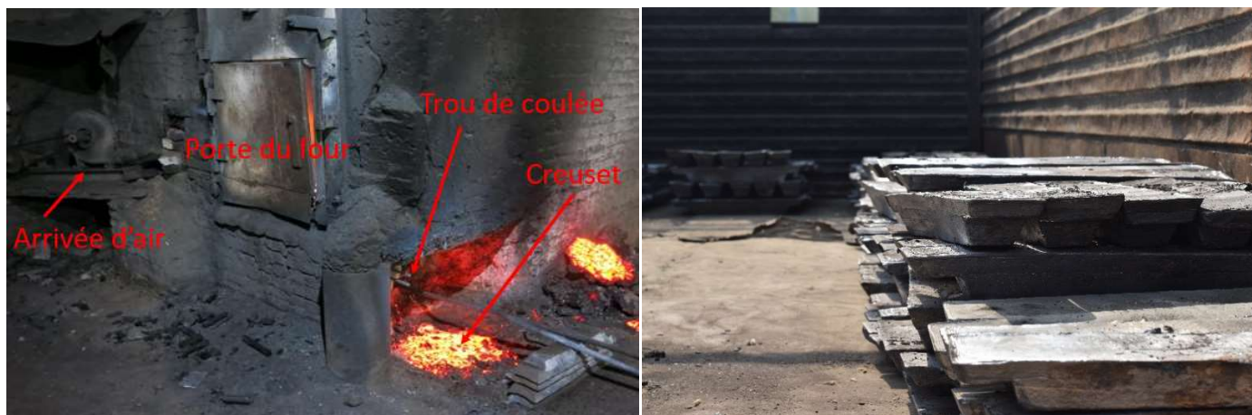
Figure 3 : (gauche) Photographie d'un four auto-construit utilisé dans un atelier du cluster de recyclage de batteries au plomb de Bhojpur, avec l'approvisionnement en air, la porte du four, le trou de coulée et le creuset (droite) Stock de lingots de plomb après coulée
