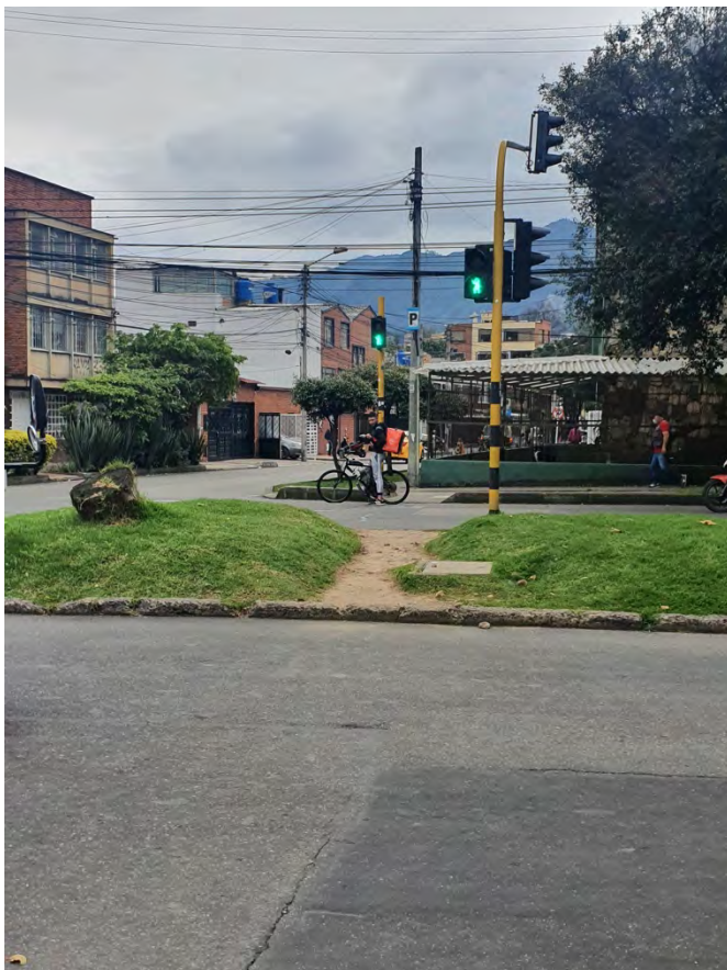
7. La ligne de désir, tracée ici par les passages répétés, et la signalisation incitent les piétons à traverser alors que l'infrastructure n'est pas adaptée dans le quartier de La Soledad (Teusaquillo) (Ducasse, 2022).
