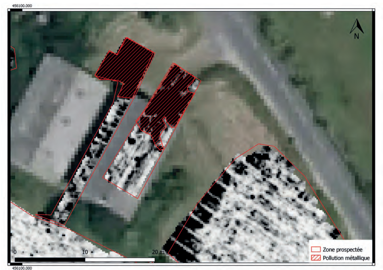
Figure 10: Pollution et saturation du signal près des hangars
