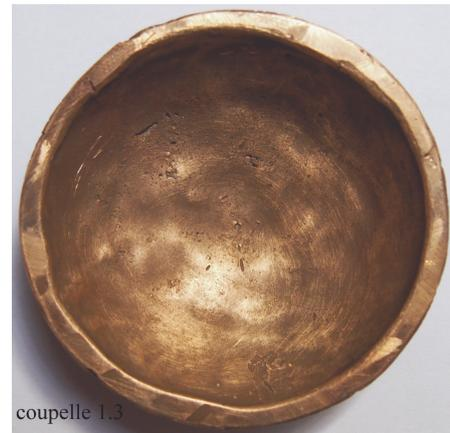
**Fig. 14** – Coupelle en bronze réalisée par procédé indirect, photo prise après polissage, face interne : surface ondulée à finition lisse (coupelle 1.3) (© J. Devogelaere).
