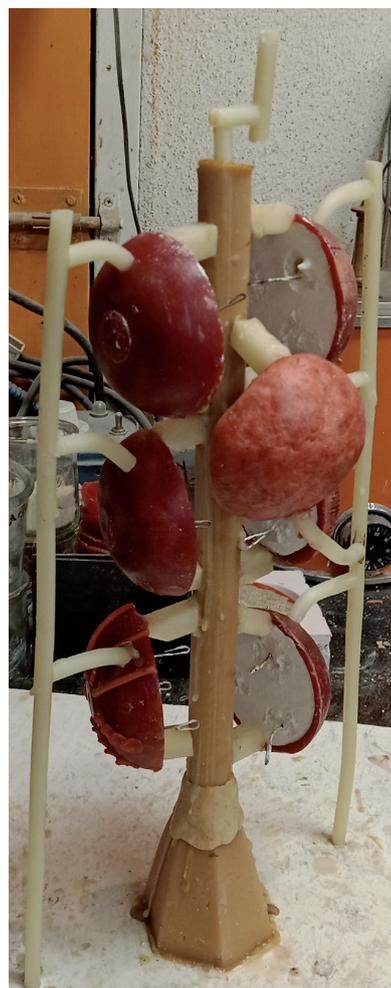
Fig. 12 – Assemblage des coupelles et éléments (pot de coulée, jet de coulée, tire-cire, événements) en cire pour permettre la coulée du bronze (© J. Devogelaere).
