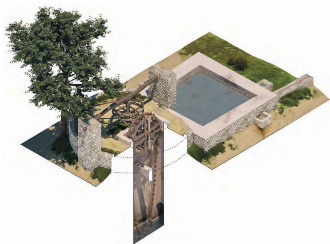
Fig. 6 — Restitution 3D du mode de fonctionnement de l' alakatin dans un état autour du XVII e siècle (P. François, LA3M).
