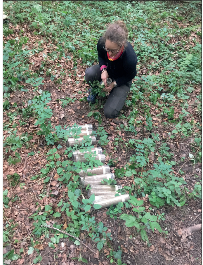
Fig. 8. Le sédiment est contenu dans des cartouches cylindriques en PVC et peut, ainsi, être aisément transporté (photo: Alexandra Winkler, UZH).
