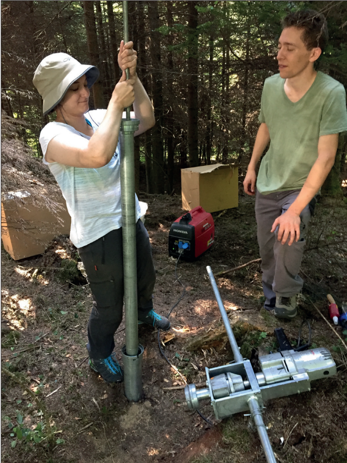
Fig. 7. Le Humax peut être utilisé facilement. En bas, à droite, le moteur de la carotteuse (photo: Alexandra Winkler, UZH).
