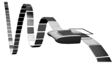
Vue d'artiste d'une machine de Turing : un ruban infini muni d'une tête de lecture/écriture. La machine dispose également d'une table de transition, non représentée sur l'image. (source: Wikipédia)
