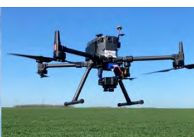
Caméra FLIR DUO (mesure IR et RGB simultanément) sous un Matrice 210 et 300
