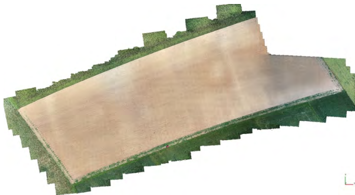
78– Traitement numérique du secteur survolé aux Fosses du Breuil : ortho-image verticale de la numérisation en nuages de points (66 493 372 points) [© G. Chaumet 2019]
