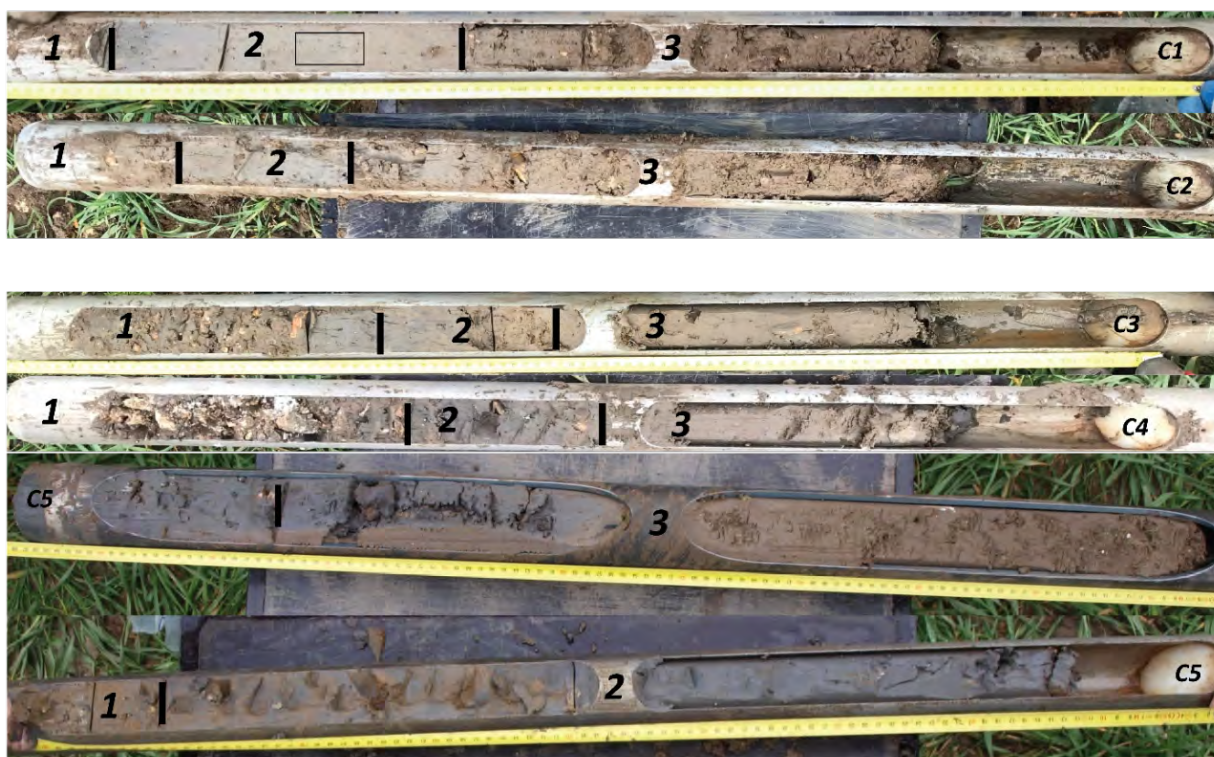
179– Séquences sédimentaires des remblaiements de chenaux de l'Eure sur la commune de Saussay au lieu-dit « Les Terres Noires » prélevées par carottage. Série sédimentaire 1 : grave à silex roulés, parfois sableuse, dans une matrice argileuse. Série sédimentaire 2 : limons argilo-sableux. Le rectangle noir localise l'échantillon prélevé pour datation radiocarbone. Celui-ci a livré une date de 4220 \pm 30 BP [Beta - 593639 ; 4626-4854 cal BP ; 2678-2905 cal BC]. Série sédimentaire 3 : limons sableux et/ou sables limoneux [© T. Piau 2021]
