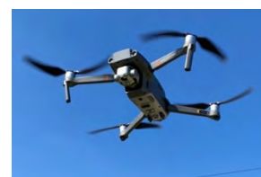
Mavic Enterprise avec caméra IR et RGB en simultanée
