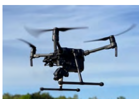
Caméra FLIR DUO (mesure IR et RGB simultanément) sous un Matrice 210 et 300
