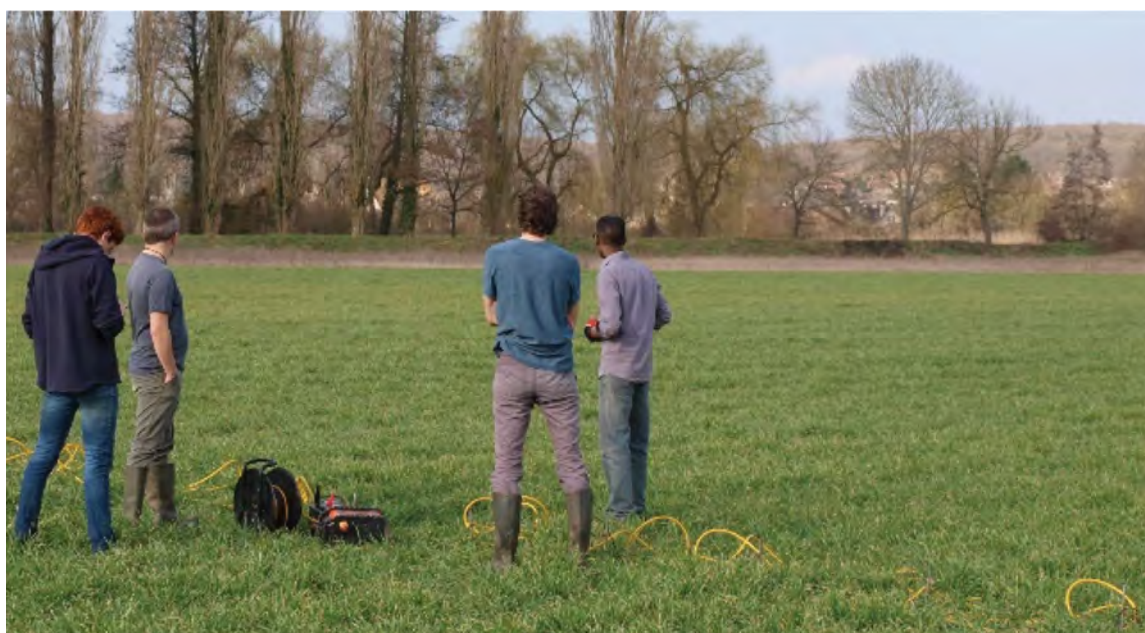
175– Profil 2 de tomographie de résistivité électrique réalisé en collaboration avec C. Virmoux (Umr 8591) au lieu-dit « Les Terres Noires » sur la commune de Saussay à l'aide d'un système multi-électrodes Abem Terrameter LS et d'un DGPS [© F. Dugast 2021]
