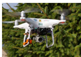
Caméra FLIR simple sous un Phantom 4 V2
