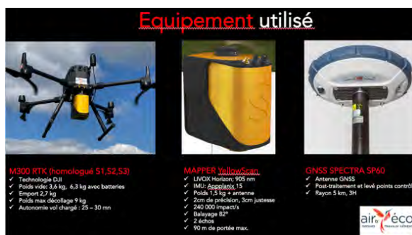
83– Équipement utilisé pour les levés LiDAR aéroporté sous drone [© air'd'éco-drone]
