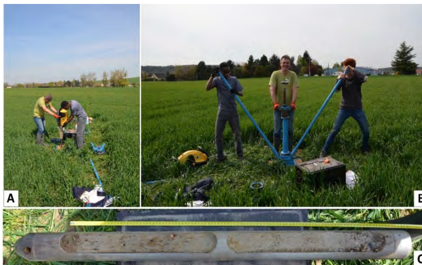
168– Carottage à l'aide d'un carottier à percussion cobra MK1 du laboratoire PRODIG (A) ; extraction de la gouge (B) ; analyses texturale et structurale de la carotte sur le terrain et sélection des prélèvements pour les analyses en laboratoire (C) [© F. Bétard & T. Piau 2019]
