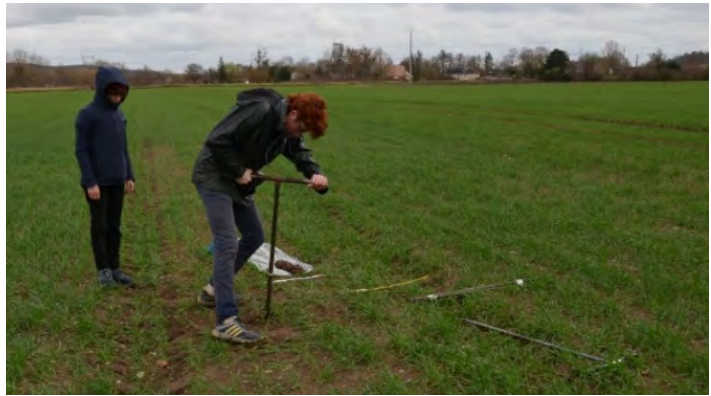
169– Sondage à la tarière pédologique dans un paléochenal de l'Eure à Garennes-sur-Eure « Bellevue » [© F. Bétard 2019]
