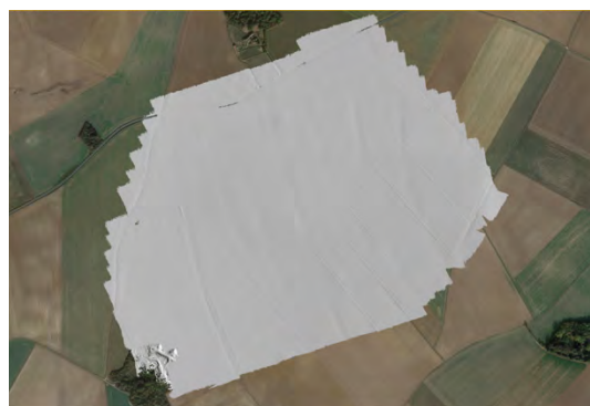
108– Guainville, levé LiDAR : MNT ombré sur fond Google (QGIS) Fz=1 [© I. Le Tellier 2021]
