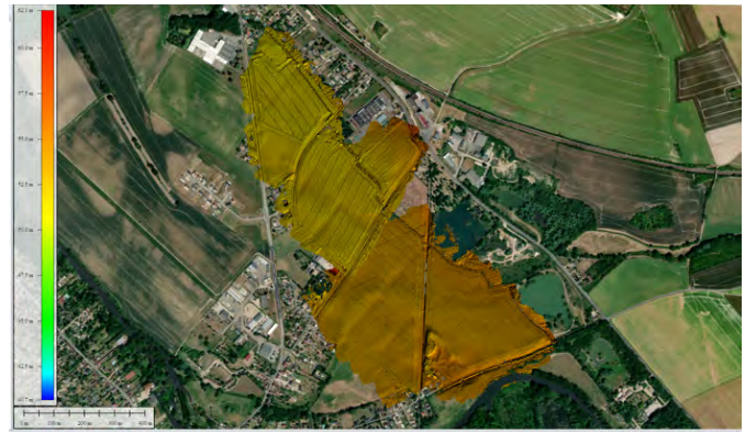
102– Garennes-sur-Eure, « Bellevue », levé LiDAR : MNT sur fond Bing Aerial, Fz=1 [© I. Le Tellier 2021]
