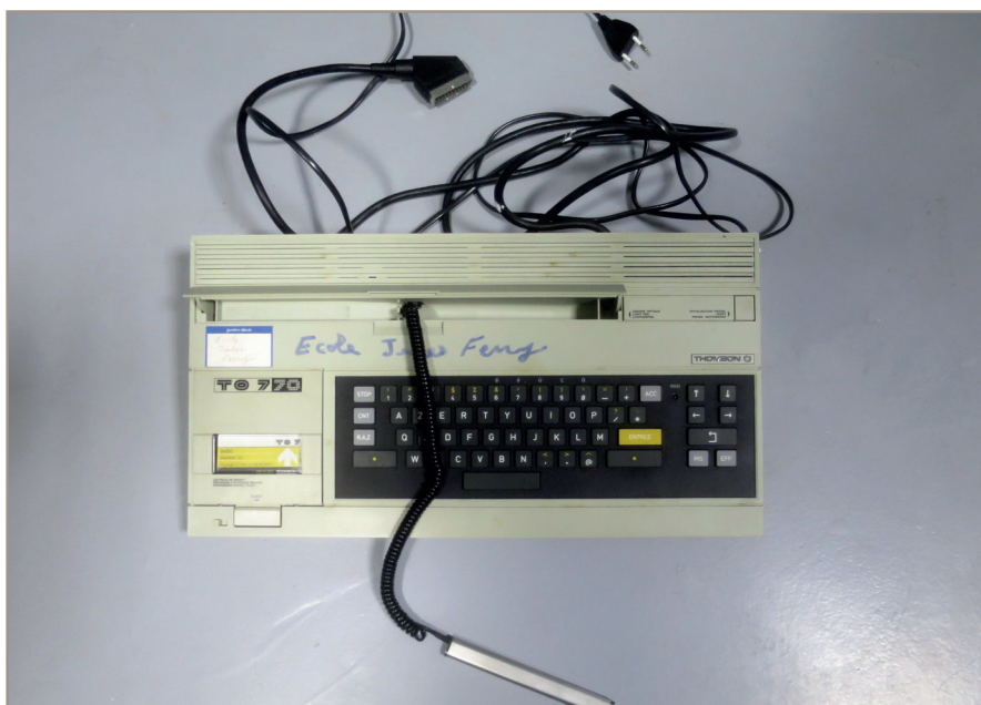
Figure 1 - L'ordinateur Thomson TO7/70, ses périphériques d'entrée (clavier et stylo optique) et câble de sortie (péritel) et leur emballage Crédits : J.-N. Lafargue
