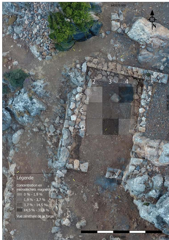
Fig. 31. Carte de répartition des microdéchets magnétiques dans les niveaux récents de la pièce 4.102.
