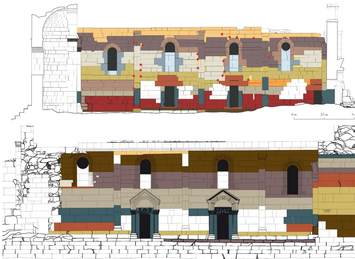
Fig. 13. Ereruyk, basilique. Etudes d'archéologie du bâti avec relevés pierre-à-pierre. - 13d. Mur sud, face intérieure. Principaux niveaux d'appareil dans les quatre travées. Raccords à échancrure (cercles rouges) ; blocs et chandelles de calage (jaune clair) ; obturations anciennes (bleu clair) ; reprises récentes en sous-œuvre (blanc). - 13e. Façade sud. Schéma des principaux niveaux d'appareil.
