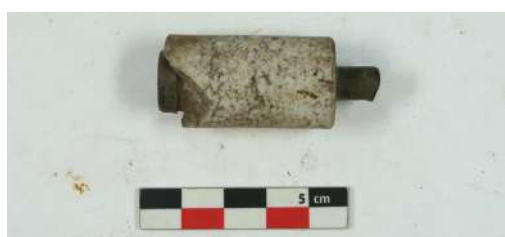
Fig. 637 : Cartouche de coupe-circuit, CXX-107-006, issue du SD1B (photographie : A. Schnepf et C. Schermann).
