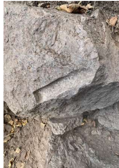
Fig. 225 : Trace de marteau perforateur sur un bloc non équarri (photographie : J. Brangé).
