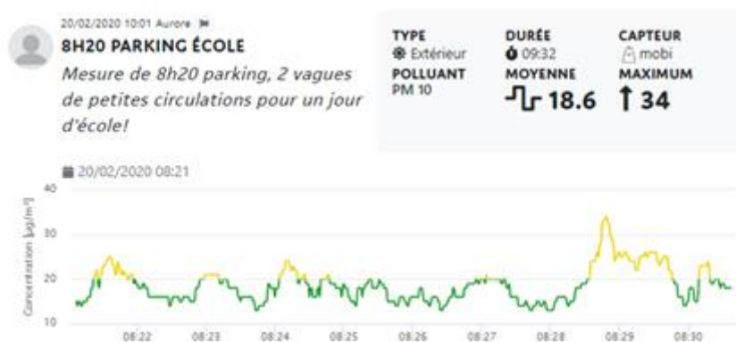
Figure 15 : Exemple de mesures réalisées pour caractériser l'air autour de l'école au moment de la dépose des enfants le matin en phase 2
