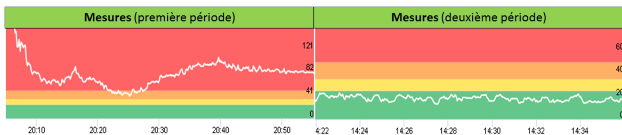
Figure 27 : Sessions de mesure du poêle à bois en intérieur avant et après l'intervention d'un professionnel installateur à la suite d'une fuite de conduit
