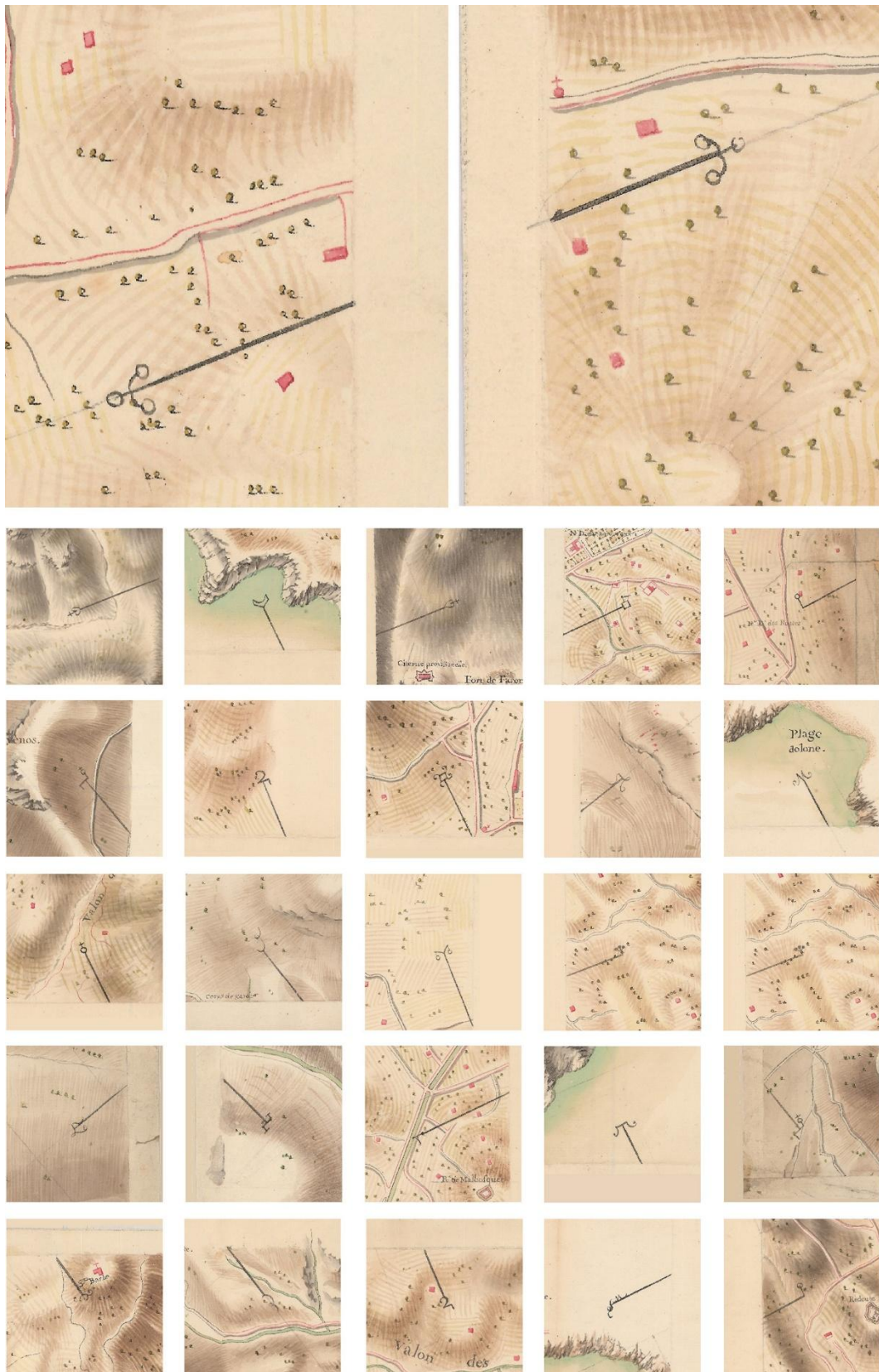
Figure 2 : Repères placés en vis-à-vis sur les feuilles contiguës. L'auteur semble s'être inspiré des signes utilisés par les charpentiers pour repérer les pièces à assembler. Composition par l'auteur d'extraits d'une carte manuscrite des environs de Toulon, sans titre et sans date (seconde moitié du XVIIIe siècle) ; document IGN, fonds des fortifications CH274.
