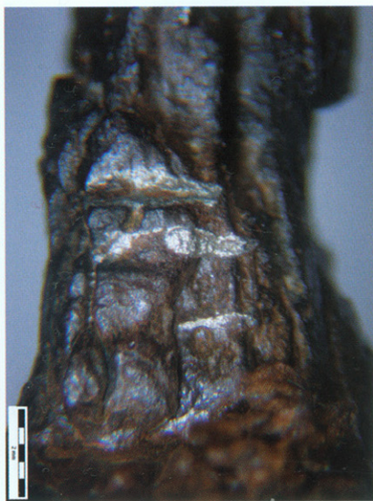
Obr. 13: Zvětšený detail ostrухy se zbytky pocínování. Fig. 13: Detail of the spur under magnification showing remains of tinning.
