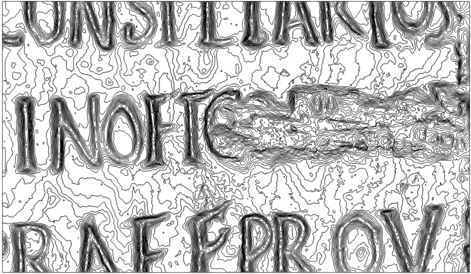
Fig. 7. Restituzione a curve di livello.
