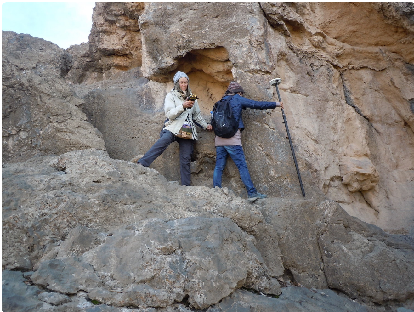
Fig. 9 : Un périlleux travail de mesure des coordonnées d'un point avec l'aide d'un GPS différentiel sur le tracé rupestre d'un canal ancien effectué par Marie-Laure Chambrade, à gauche, et Marzieh Mehrabani, à droite, dans la vallée du Tang-e Bolaghi au sud de Pasargades à l'automne 2018 (photo : Kourosch Mohammadkhani).
