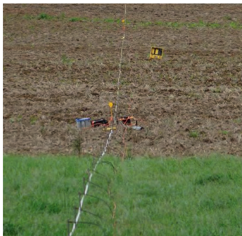
Illustration iii : Section de résistivité électrique en place avec 64 électrodes disposées en ligne et rattachées à deux flûtes. Au milieu, les deux flûtes sont connectées au résistivimètre Terrameter LS ( ABEM ).
